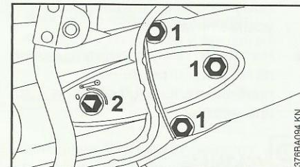
Перед натяжением поликлинового ремня гайки (1) должны быть отвинчены и стрелка на натяжной гайке (2) должна указывать на 0.
