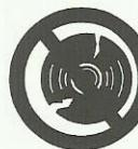
Чаще контролировать отрезной круг – круг немедленно заменить, если обнаружены трещины, искривления или другие повреждения (например, перегрев) – вследствие поломки опасность несчастного случая!
