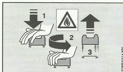
Никогда не открывайте байонетное запорное устройства бака с помощью инструмента. При этом можно повредить запорное устройство и топливо будет вытекать.
