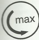
Допустимое число оборотов отрезного круга должно быть равным или больше чем максимальное число оборотов шпинделя абразивно-отрезного устройства! - см. главу "Технические характеристики".
