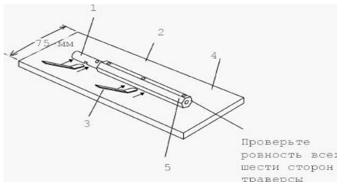
Рис.23. Проверка ровности траверсы:
