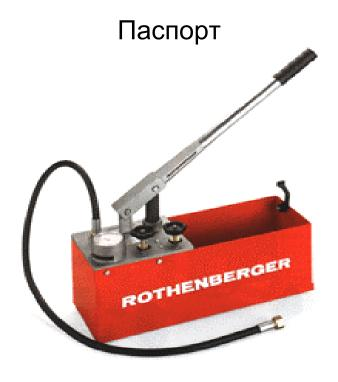
Ручной опрессовочный насос PR 50 для точной и быстрой проверки давления, а также герметичности трубопроводных систем и резервуаров в водопроводных, отопительных и сантехнических системах, в системах сжатого воздуха, паровых, в системах сжатого воздуха, паровых, охладительных и масляных установках, для котельных и при строительстве напорных резервуаров, идеален для заполнения солнечных батарей.
