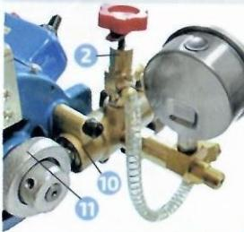
Перечень узлов насоса разборка и обслуживание которых допустимо.
