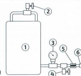
Подсоедините к насосу всасывающий и сливной шланги. На всасывающий шланг установите фильтры грубой и тонкой очистки (если жидкость для испытания чистая без взвеси и осадка - достаточно только фильтра тонкой очистки). Опустите всасывающий шланг в ёмкость с жидкостью для испытаний, а сливной закрепите над уровнем жидкости. Убедитесь, что сливной шланг не имеет перегибов.
