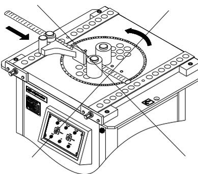
**РИСУНОК 9** Неправильное расположение единичной арматуры при гибке с помощью гибочных стаканов.
