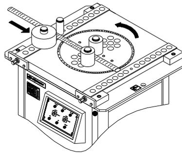
**РИСУНОК 5** Правильное расположение рабочего материала при групповой гибке с помощью гибочных стаканов.
