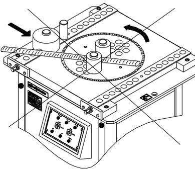
**РИСУНОК 11** Неправильное расположение нескольких единиц арматуры при гибке с помощью гибочных стаканов.
