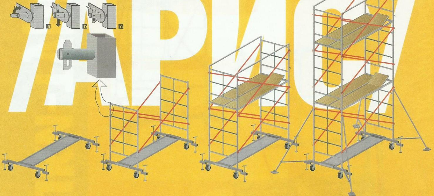
Возможность использования несущих элементов одного проекта в другом позволяет создать целую гамму вышек-тур с различными размерами рабочих площадок, представленных в **таблице**.
